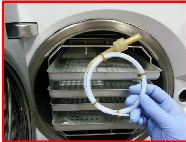
**Le test de Hélix (classe 6)** montre la capacité à stériliser les corps creux ou des objets à cavité profonde et étroites.
