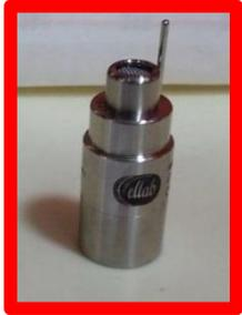
**Le système embarqué** est un système électronique autonome, souvent en temps réel ; spécialisé dans une tâche bien précise. Le terme désigne aussi bien le matériel pour le logiciel utilisé. La sonde embarquée, autonome est placée dans l'autoclave permettant le contrôle périodique des paramètres de l'équipement .
